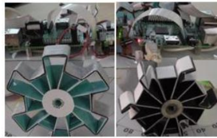
Gambar 6. Setup Roda Normal (kiri) dan Roda Rusak (kanan)
