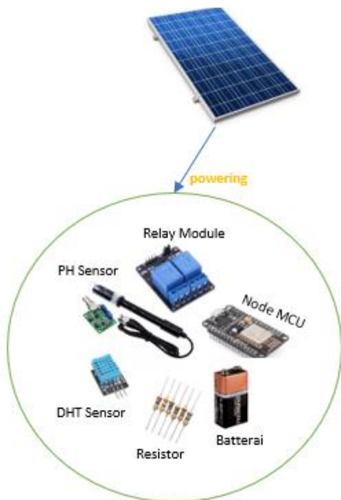
Gambar. 3. Pembuatan Perangkat Sistem Monitoring PH
