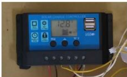
Gambar. 12. Charger controller yang digunakan pada sistem
