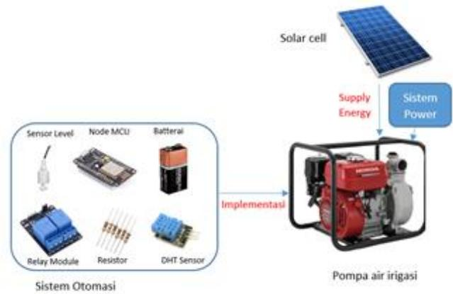
Gambar. 5.Sistem pompa dan sistem power
