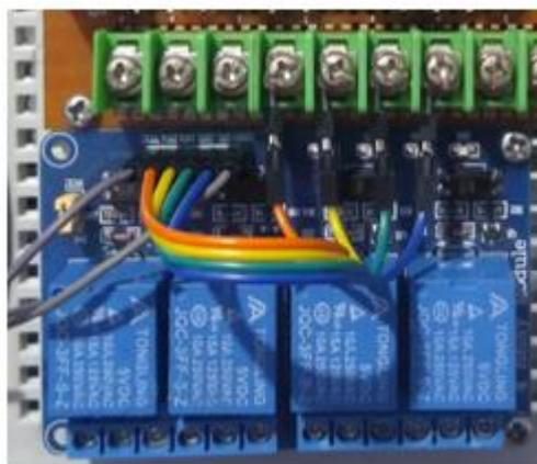
Gambar. 11. Aktuator Relay
