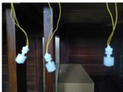
Gambar. 9. Detektor Air
