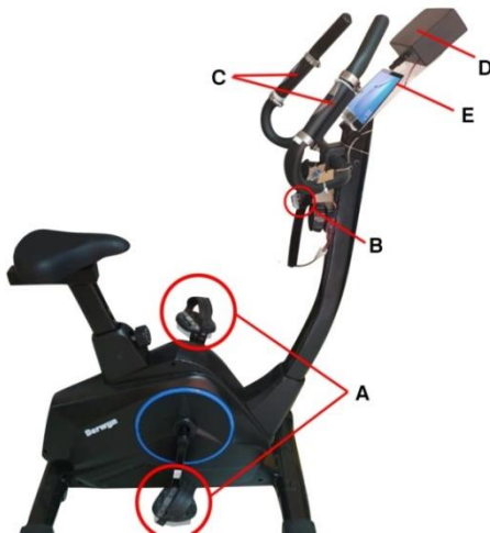
Gambar 1. Perangkat simulator VRAC: A) modul keseimbangan dan gaya berjalan; B) modul pengukur denyut jantung; C) modul kendali stir; D) modul akuisisi dan pengolahan data; E) modul penampil simulasi
